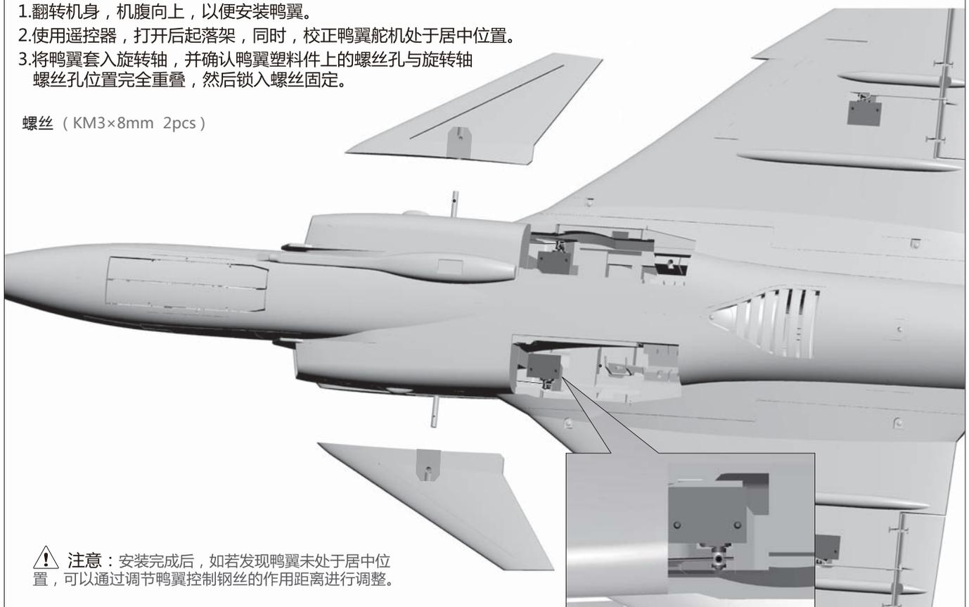
**⚠ 注意：**安装完成后，如若发现鸭翼未处于居中位置，可以通过调节鸭翼控制钢丝的作用距离进行调整。
